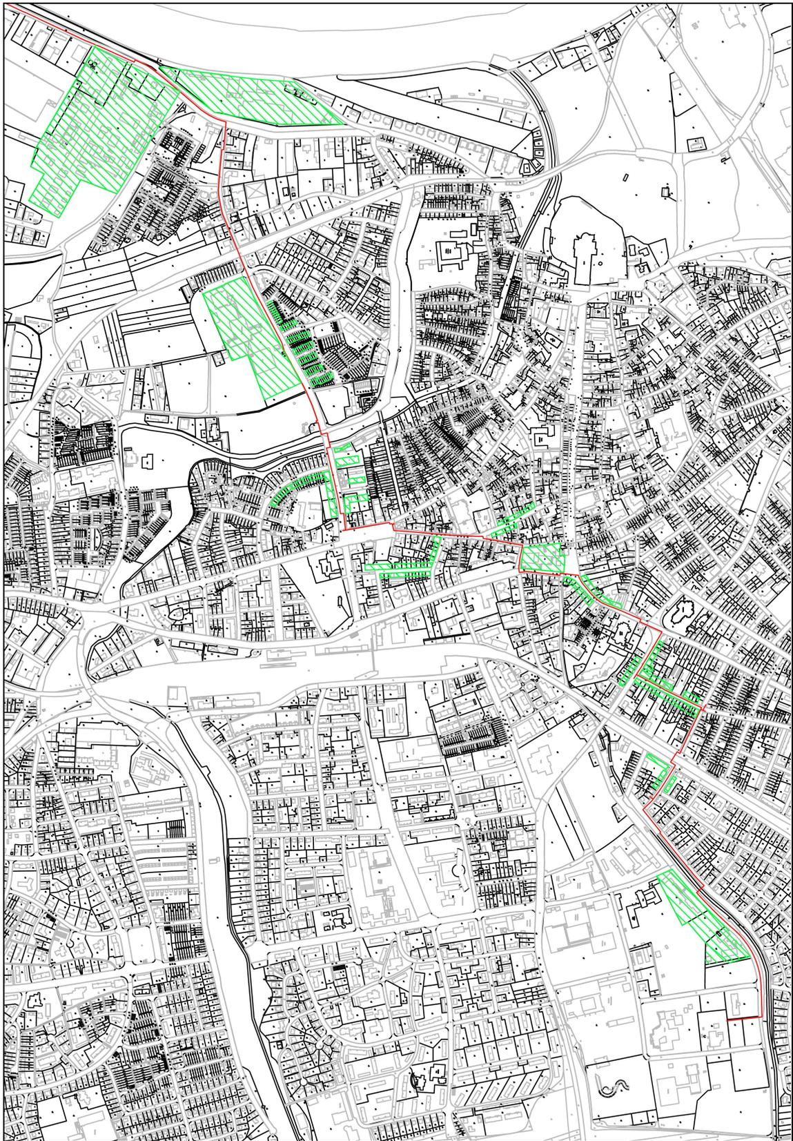
**Abbildung 30: Erweiterungsmöglichkeiten entlang der Fernwärmetrasse**
