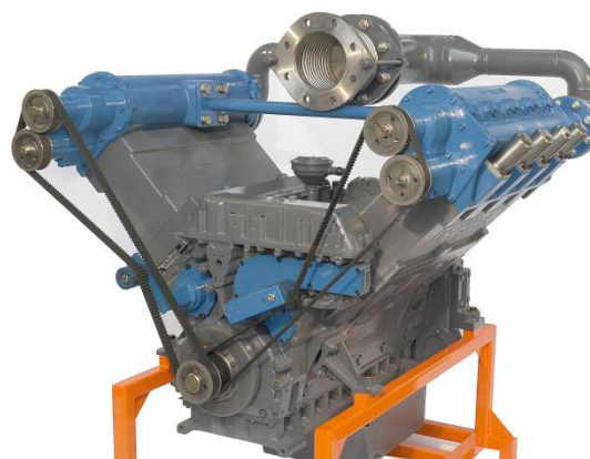
Abbildung 16: ORC-Motor: Funktionsschema und Ansicht (Fa. Devetec)
