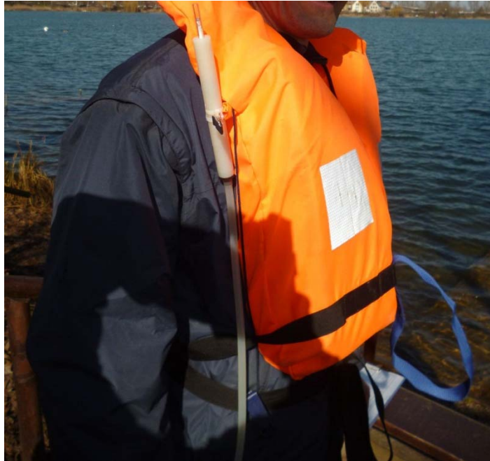
Foto Nr. 9: Probenahmeverrichtung für Bootsbefahrung (PS3 Bootsfahrt)
