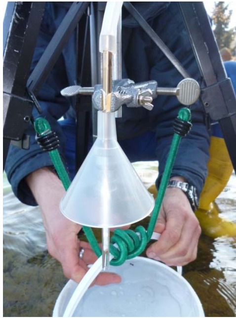
Foto Nr. 5: SVI-Tube (Probenröhrchen) mit Regen-/Spritzschutz
