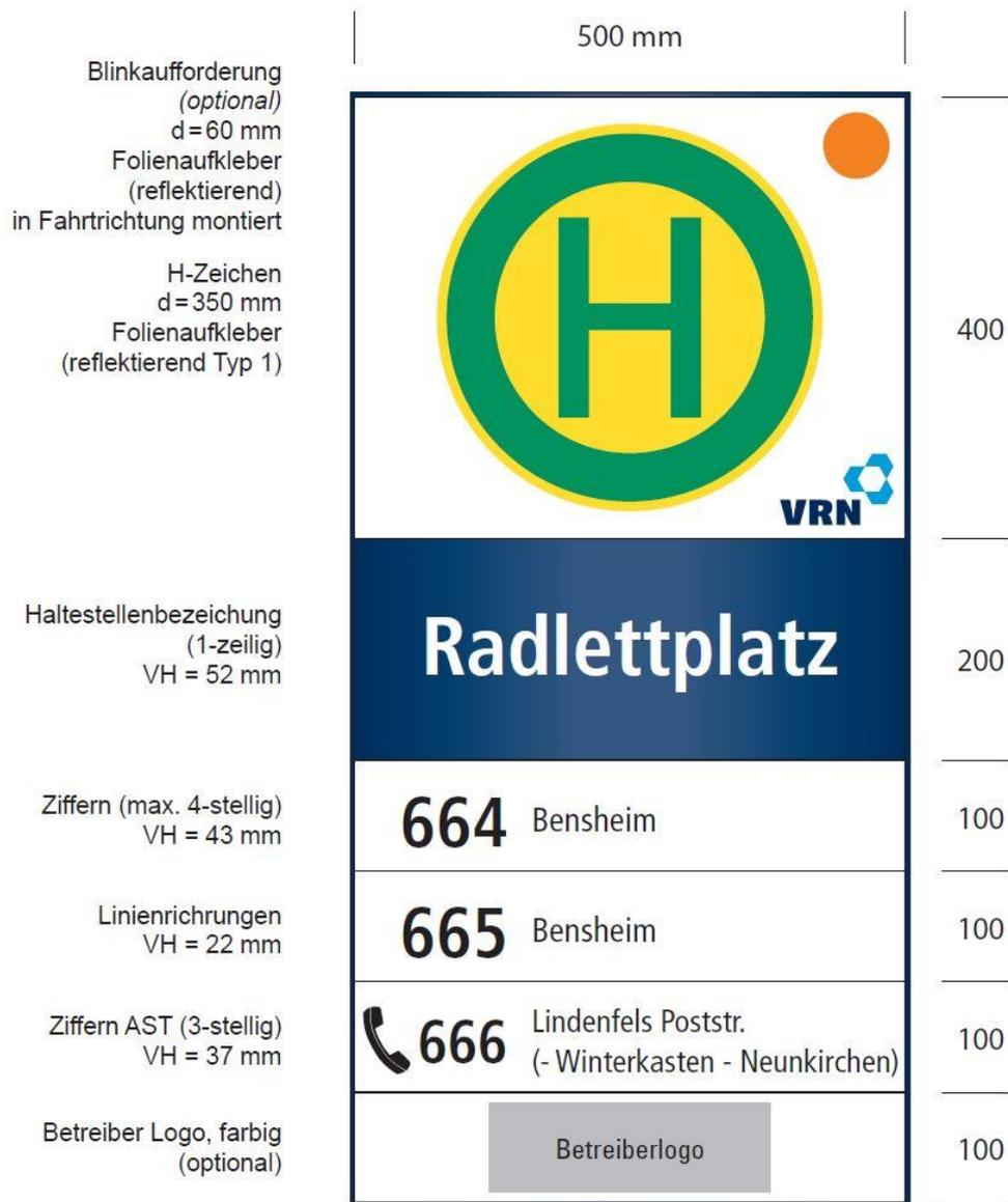
Abbildung 37: Wechselschildsystem mit gewölbter Oberfläche (höherwertiges System)
