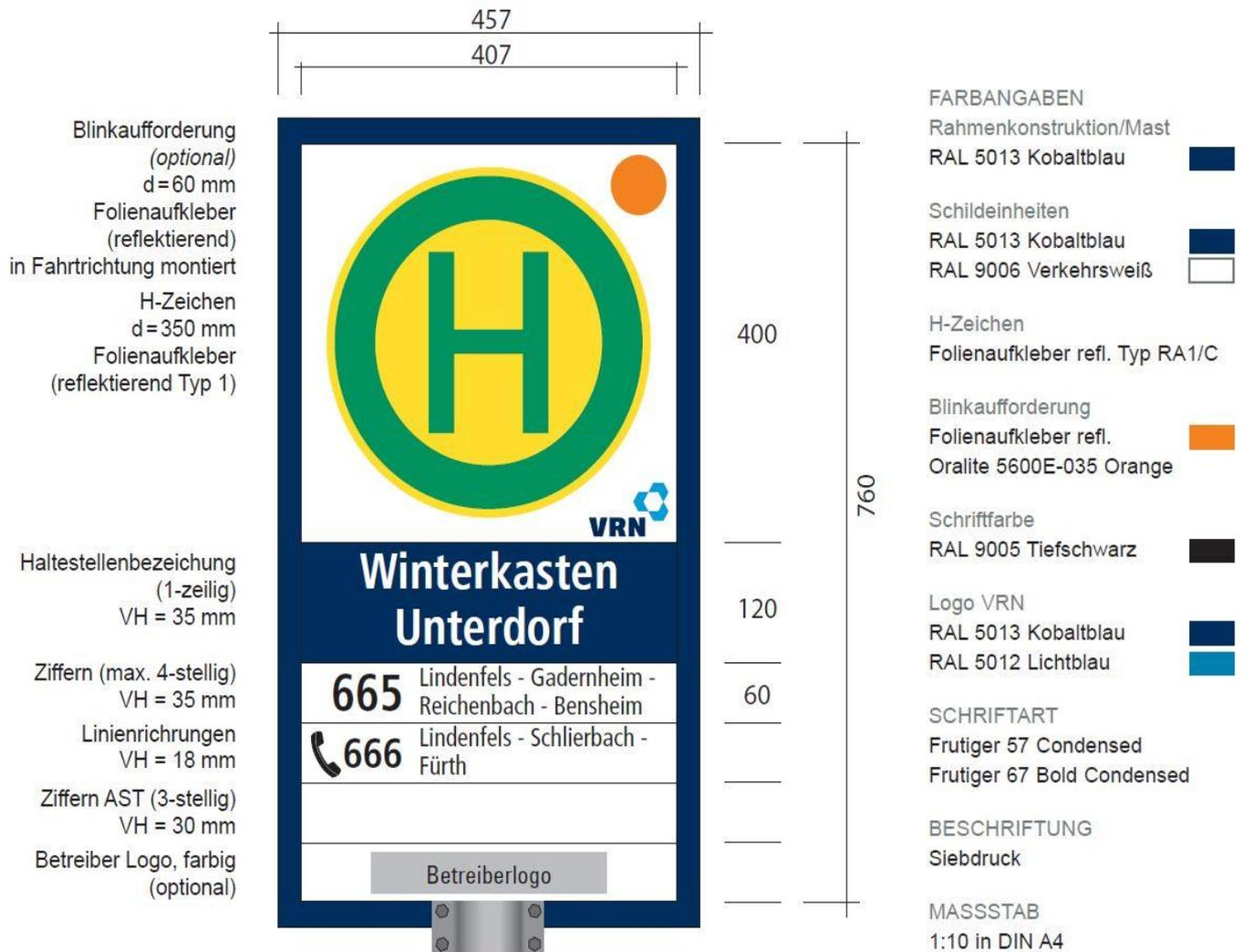
Abbildung 34: Wechselschildsystem (Standard)
