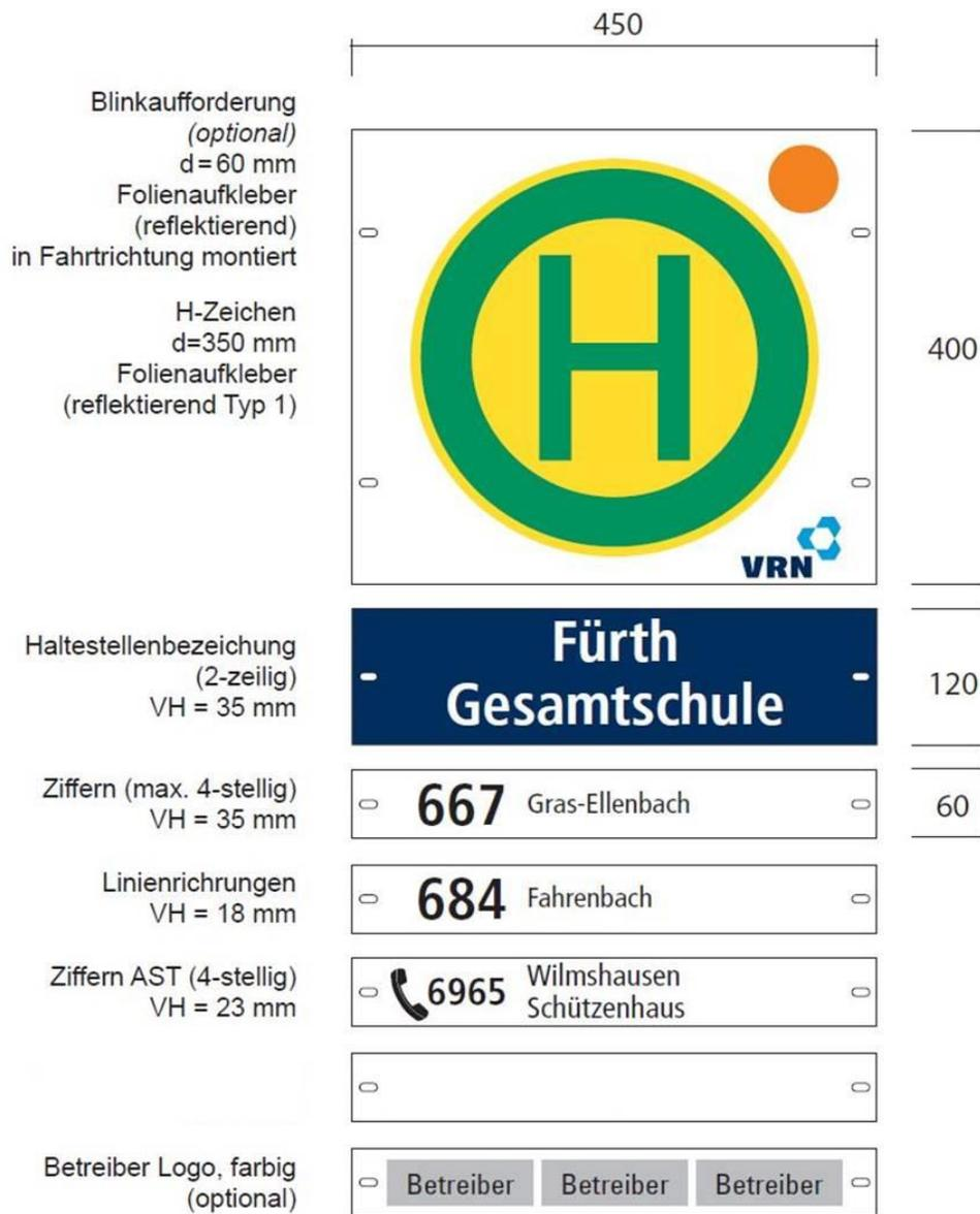
Abbildung 35: Wechselschildsystem (Standard)
