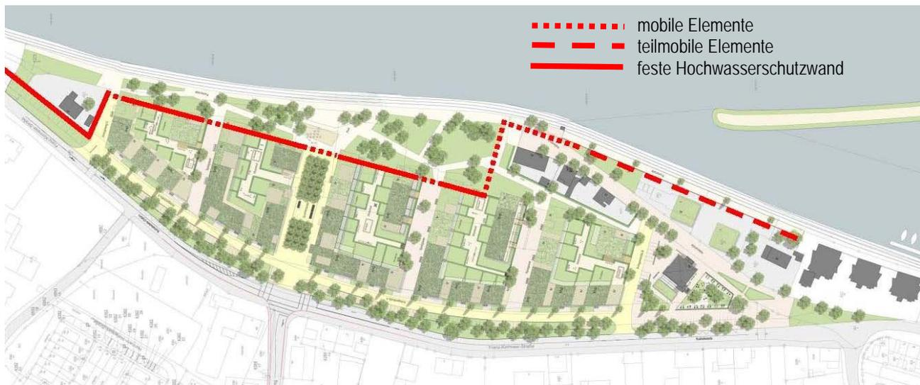
ABBILDUNG 26: HOCHWASSERSCHUTZLINIE, STAND 19.11.2012, OHNE MAßSTAB
