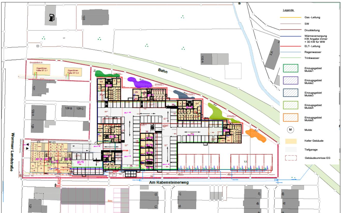
ABBILDUNG 17: ENTWURF VORHABEN UND ERSCHLIEßUNGSPLAN; ERSCHLIEßUNG UND ENTWÄSSERUNG, VERFASSER: AS+P / PBS 27.09.2021, ohne Maßstab
