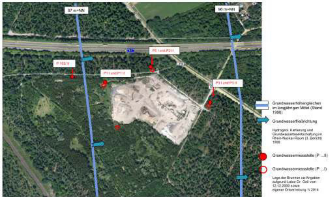
Abb. 1 Örtliche Kontrollbrunnen und Grundwasserfließrichtung
