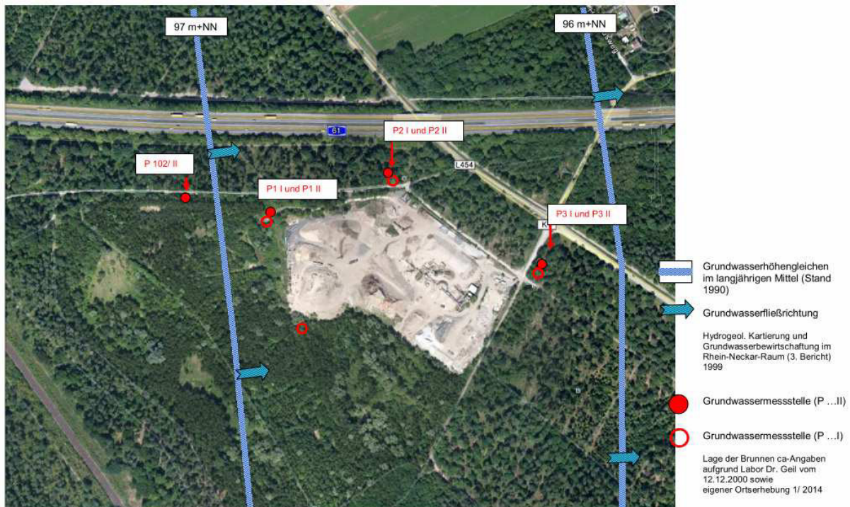
Abb. 5 Grundwasserfließrichtung und Beobachtungspegel
