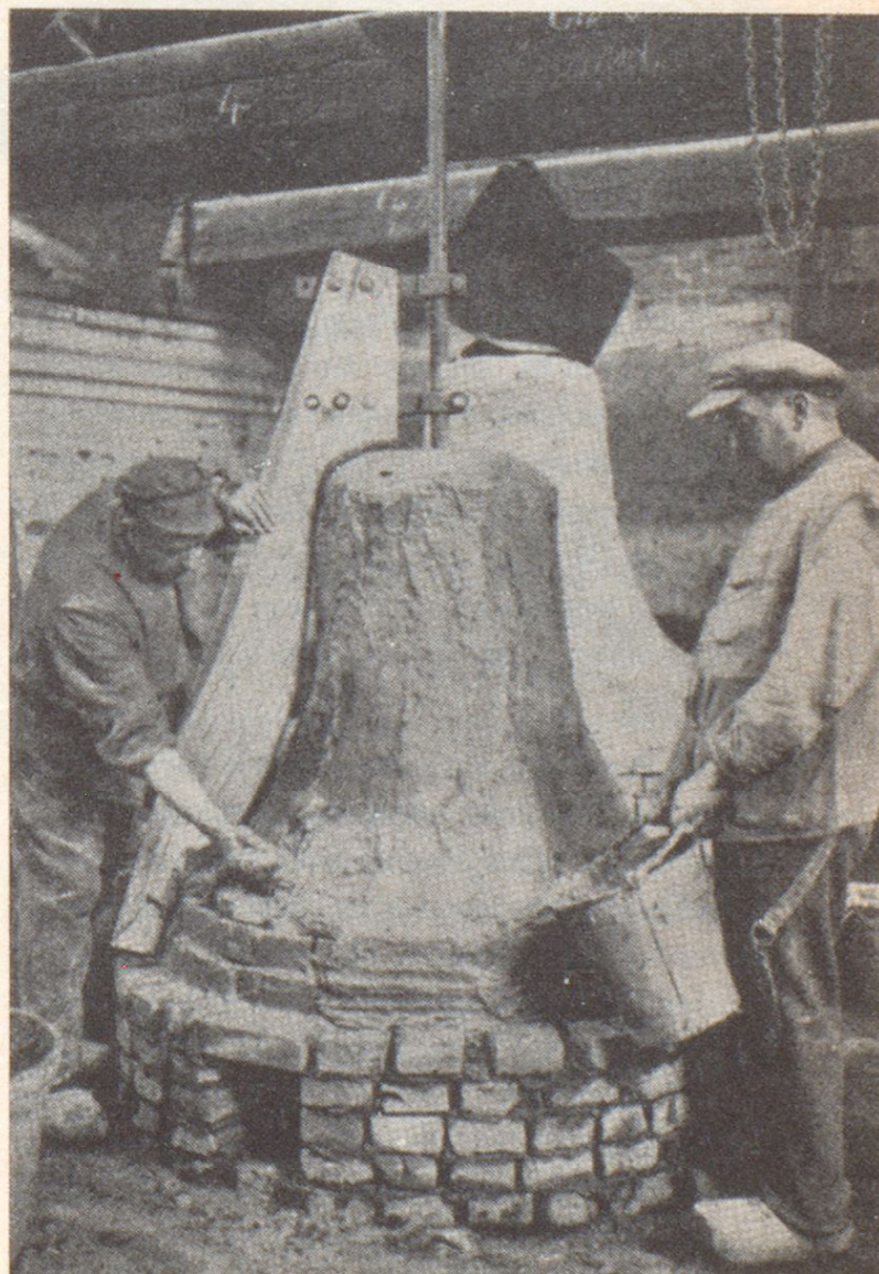
Die Arbeitsweise der Glockengießer hat sich im Laufe der Zeit nicht wesentlich verändert: aus Steinen und Lehm wird der Kern der Gußform in einer Grube von Hand hochgemauert, innen hohl, damit sie durch ein Feuer gut ausgetrocknet werden kann (Fest gemauert, in der Erden, steht die Form, aus Lehm gebrannt . . .“)
